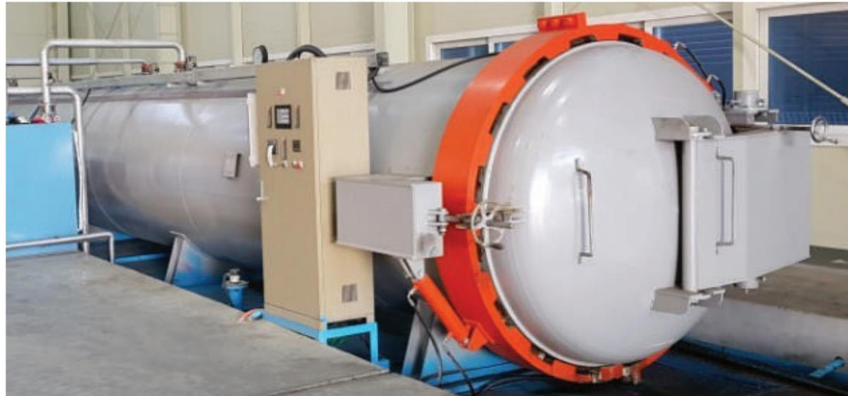
방부목은 말 그대로 목재에 방부처리를 하여 만든 가공목재입니다. 실외나 습기가 많은 곳에 쓰일 목적으로 생산된 제품으로 부패와 해충으로부터 저항할 수 있는 화학제를 압력으로 목재에 주입하여 생산합니다. 이런 방부처리는 목재의 기본적인 특성은 그대로 살리면서 목재의 수명을 늘려 줍니다.
